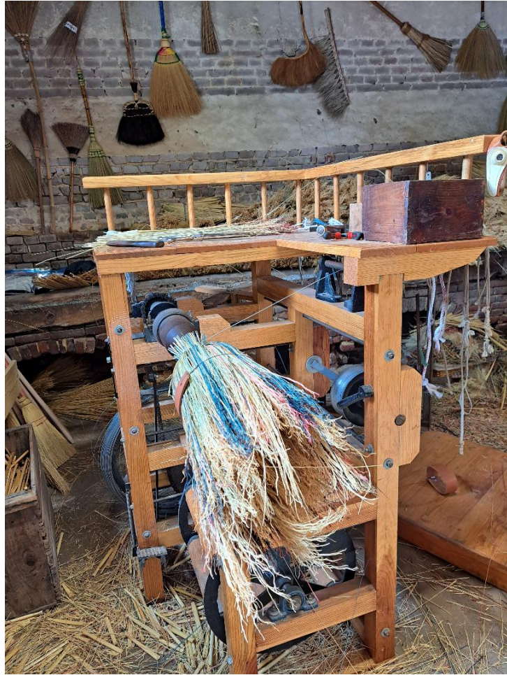
Machine à confectionner le balai : tout est manuel
