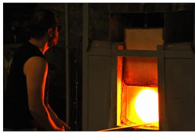
Nous passons ensuite dans la « salle des fours » ; il en a 3 avec des différences de fonction et de température : au milieu, le four qui dégage le plus de chaleur (1400 à 1500°C) dans lequel les ingrédients qui vont composer le verre sont
